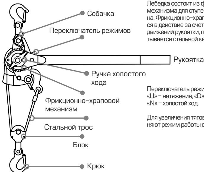
Лебедка состоит из фрикционно-храпового механизма для ступенчатого вращения барабана. Фрикционно-храповый механизм приводится в действие за счет возвратно-поступательных движений рукоятки, при этом на барабан наматывается стальной канат
