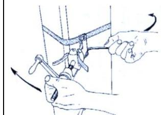
Далее необходимо таким же образом закрепить верхнюю часть кронштейна CS 10.3 вторым отрезком ленты со скрепой.
