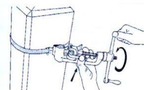
Вращением воротка инструмента CVF натянуть ленту с необходимым усилием, отвести инструмент CVF в сторону, загибая конец ленты в сторону «усов» скрепы, и вращением рукоятки резака инструмента CVF отрезать свободный конец ленты.
