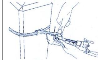
Затем свободный конец ленты нужно вложить в прорезь головки инструмента CVF под защелку. Рукоятка резака инструмента CVF в этот момент должна быть прижатой к корпусу инструмента.
