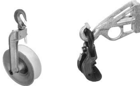
Крепление промежуточной подвески ES 1500 (ES 800) к опорам производится при помощи металлической ленты F207 и скрепы NC20; если в опоре есть технологическое отверстие, то промежуточная подвеска может крепиться на болт. Ролики RT 1 крепятся за отверстие в кронштейне промежуточной подвески ES 1500 (ES 800).
