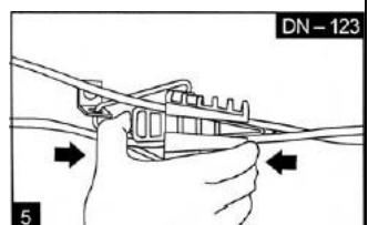
Закрепляет в зажиме DN 1 (для однофазного ввода) или DN 123 (для трехфазного ввода) жгут проводов ввода, заклинивая одним клином зажима оба провода (проводы должны располагаться по обе стороны клина). При заклинивании проводов ввода необходимо оставить свободные конца проводов длиной, достаточной для подсоединения их к магистрали (40-60 см).
