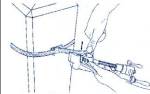
Затем свободный конец ленты нужно вложить в прорезь головки инструмента CVF под защелку. Рукоятка резака инструмента CVF в этот момент должна быть прижатой к корпусу инструмента.
