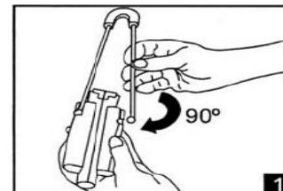
3. Вытягивает пластмассовые клинья зажима из корпуса в сторону тросовой петли до упора, тем самым, раздвигает их в стороны.
