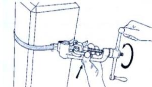
Вращением воротка инструмента CVF натянуть ленту с необходимым усилием, отвести инструмент CVF в сторону, загибая конец ленты в сторону «усов» скрепы, и вращением рукоятки резака инструмента CVF отрезать свободный конец ленты.
