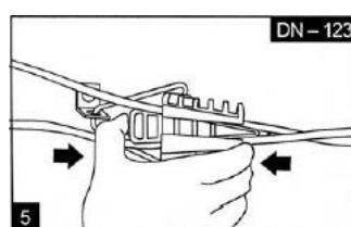
Закрепляет в зажиме DN 1 (для однофазного ввода) или DN 123 (для трехфазного ввода) жгут проводов ввода, заклинивая одним клином зажима оба провода (проводы должны располагаться по обе стороны клина). При заклинивании проводов ввода необходимо оставить свободные конца проводов длиной, достаточной для подсоединения их к магистрали (40-60 см).
