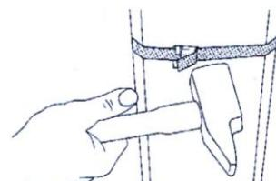
Член бригады (III гр.) на опоре закрепляет на кронштейне СА 16 анкерный зажим DN 1 или DN 123, продевая съемную скобу зажима в кольцо кронштейна.
