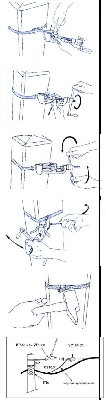
заделки троса в посадочном гнезде на 90°.
