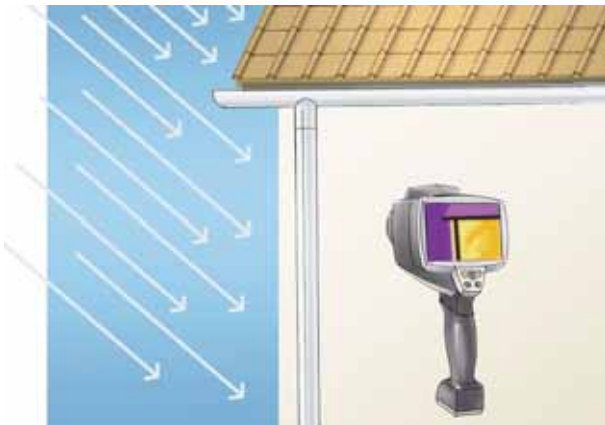
Рис. 2.1: Отражение при измерениях проводимых на открытом воздухе
